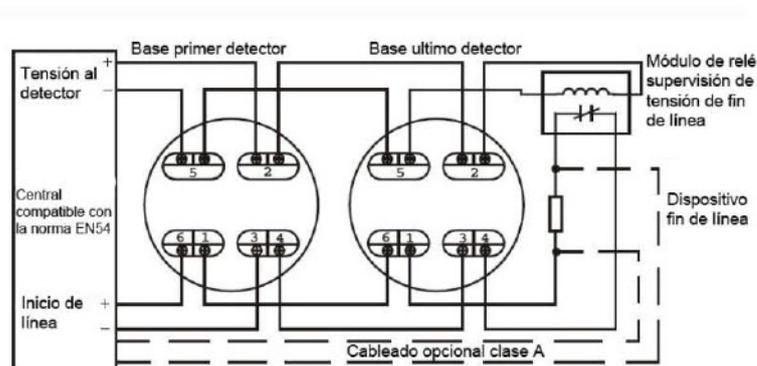
Diagrama típico del cableado del sistema de detección de humo convencional con 4 hilos.
