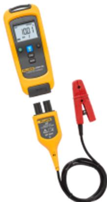
La sonda de corriente a3004 FC es una sonda que transmite medidas de corriente DC a otros receptores habilitados Fluke Connect™,
