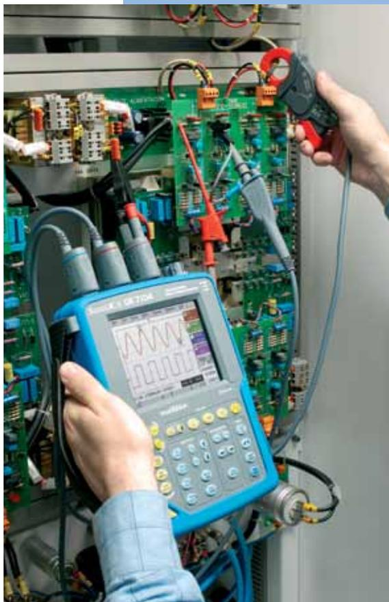
En el ámbito de la innovación, METRIX no se conforma sólo con lanzar el primer osciloscopio de cuatro canales aislados 600V / Cat.III autónomo y portátil del mercado. Por ello, por su ergonomía, polivalencia y seguridad o por sus diferentes modos de comunicación, los OX 7000 fueron diseñados con el requisito de ofrecer la mejor relación seguridad-prestaciones / facilidad de empleo.
