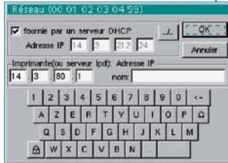
La configuración de la comunicación es muy simple ya que, en la mayoría de los casos, la dirección IP del instrumento la proporciona automáticamente el servidor local; sólo se necesita entrar la dirección de la impresora a utilizar.
