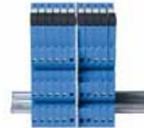
2. Manteniendo la pestañas en su lugar proporciona una separación de 6.2mm. Con un simple corte (con tijera) del segmento/segmentos pertinente, permite la interconexión a través del separador de 2 grupos diferentes de interfaces, utilizando los puentes estándar.
