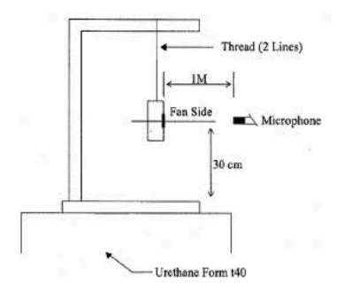
1 METER FROM MICROPHONE TO FAN INTAKE
