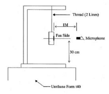
1 METER FROM MICROPHONE TO FAN INTAKE
