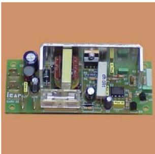
Especialmente pensados para el campo de las telecomunicaciones, control industrial, automoción, navegación, transporte de mercancías y viajeros, ferrocarril, etc, los convertidores de corriente continua ICAR de la serie KIT elevan la tensión de 12/24V de la batería utilizando técnicas de conmutación de alta frecuencia que permiten obtener la máxima potencia con el mínimo volumen y peso, y con el mayor rendimiento.
