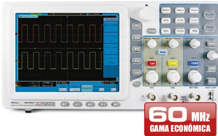
El **OD-606** de **PROMAX** es un osciloscopio digital que presenta un ancho de banda de hasta 60 MHz y una tasa de muestreo en tiempo real de hasta 500 MS/s. Este osciloscopio digital de gama económica dispone de una pantalla de grandes dimensiones de 8”.
