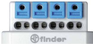
Entradas de bornes duplicadas para facilitar la conexión de puentes o de otros componentes en paralelo. Sección máxima de hilo admitida: 2.5 mm<sup>2</sup>.
